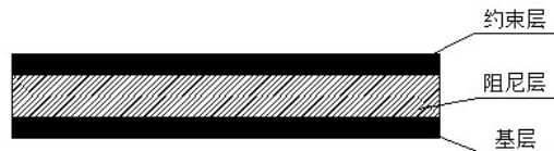
图10 约束阻尼隔声结构
